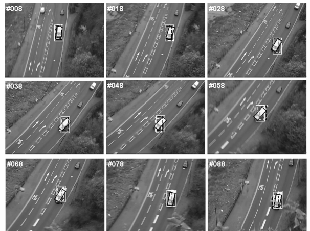
图6 五种算法对发生旋转的刚性矩形目标(bus)的跟踪结果比较,白色虚线框、白色实线框、黑色虚线框、黑色实线框依次为ABBMM、FBM、IHBM和RIHBM跟踪的结果.本文算法所测旋转角度依次为 2^\circ, 17^\circ, 31^\circ, 45^\circ, 49^\circ, 50^\circ, 32^\circ, 14^\circ, 13^\circ .
